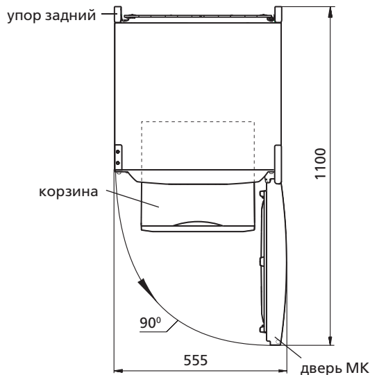
Рисунок 2 — Холодильник (вид сверху)
